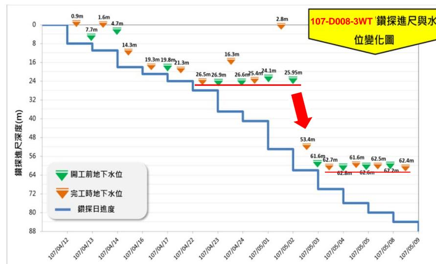
上圖：鑽破阻水層後、水位洩降
